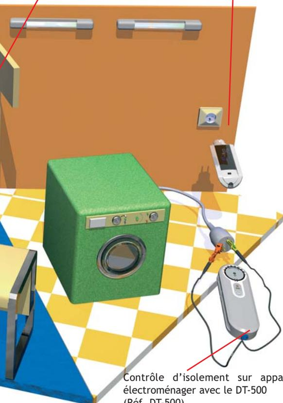
Contrôle d'isolement sur appareil
